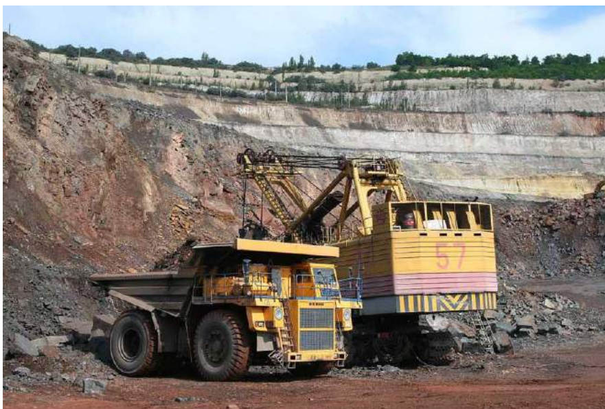
Рис. 4.8. Погрузка горной массы в автомобили БелАЗ (СГОК)
